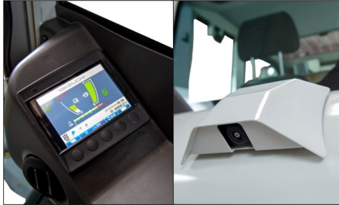
Neues, kratzfesteres Display aus anlaufresistentem Verbundglas, sowie ein Werkstattmenü mit neuen Funktionen. Einblendung der Rückfahrkamera erfolgt automatisch.
