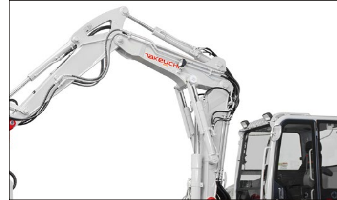
TB290-2 auch mit Verstellausleger erhältlich. 4 Steuerkreise, davon 3 proportional gesteuert, regulierbare Literleistung.
