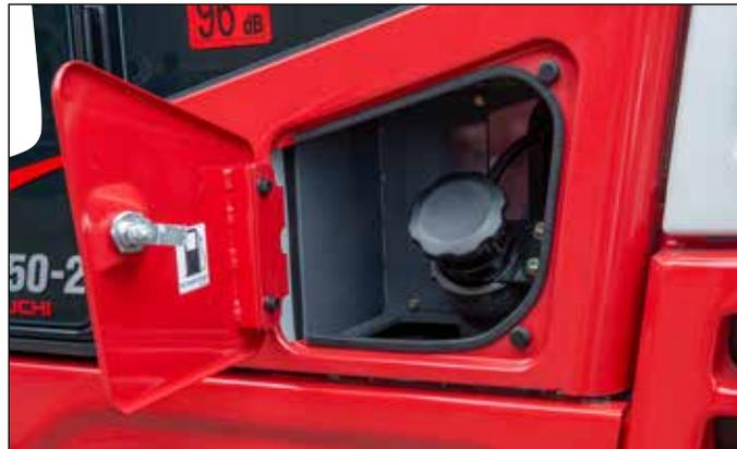
Zusätzliche Öffnungsklappe für optimalen Zugang zum Tankdeckel.
