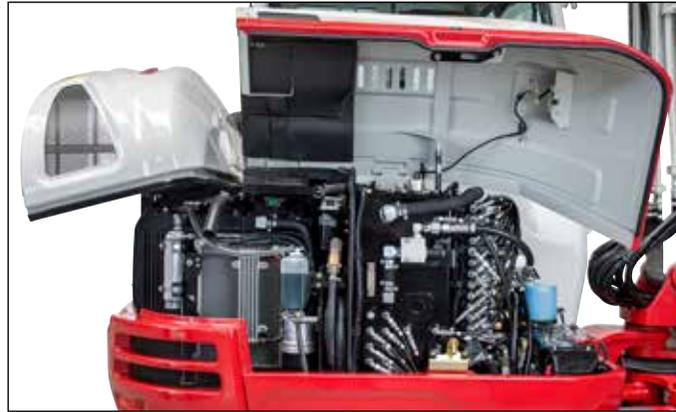
Großzügige Wartungskappen für servicefreundlichen Zugang zu Motor, Hydraulikaggregaten und Betankungspumpe.
