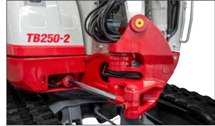
Robuster Schwenkbock mit besonders geschützter Schlauchführung und hydraulischer Seitenversetzung mit Büchsen in allen Positionen.
