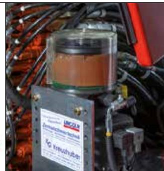
Mengengesteuerte Zentralschmieranlage mit Leerstandsmeldung
