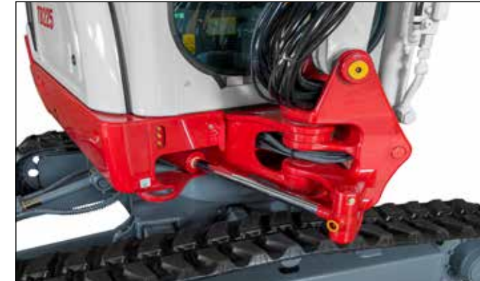
Robuster Schwenkbock mit besonders geschützter Schlauchführung und hydraulischer Seitenversetzung.
