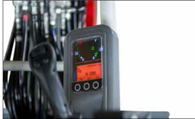
Neues, kratzfestes Display aus anlauffresistentem Verbundglas, mit optischen und akustischen Überwachungseinheiten.
