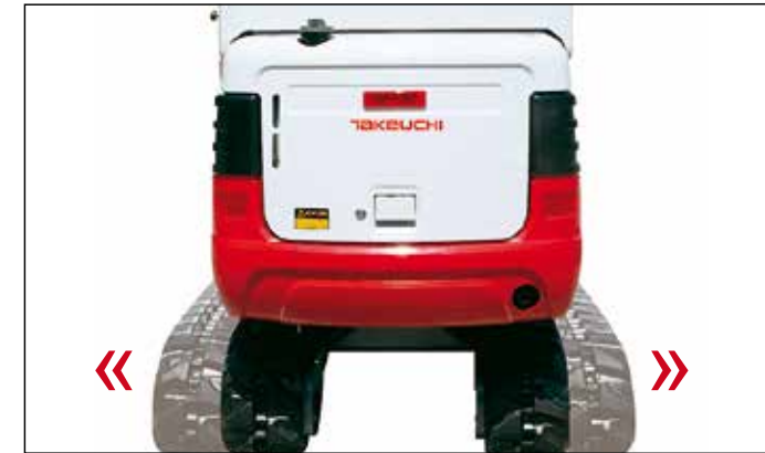
Raupenwerk mit hydraulischer Spurverbreiterung.
