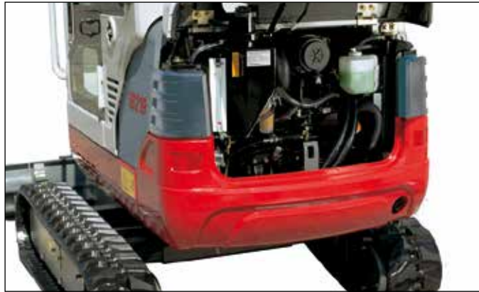
Abgas- und lärmreduzierte Motorenserie mit doppeltem Luftfilter und geräumigem Motorraum; seitlich hochgezogenes Kontergewicht.
