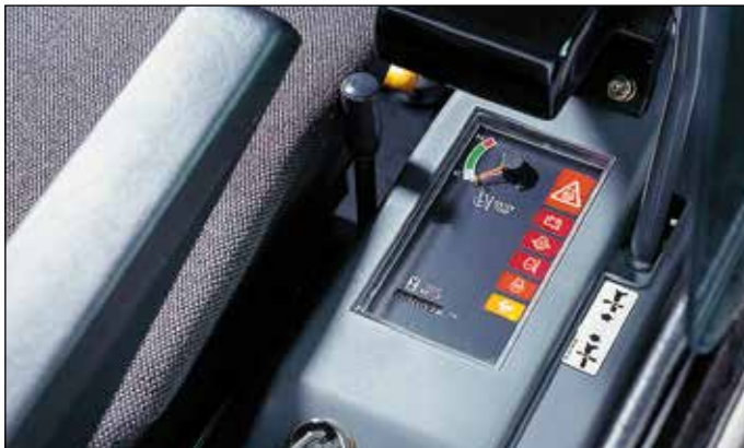
Übersichtliches Armaturenbrett mit hör- und lesbaren Warnungen im Falle einer Störung während des Betriebes.
