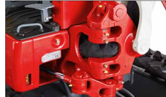
Robuster Schwenkbock mit Schwenkzylinder. Hubzylinder mit Endlagendämpfung.
