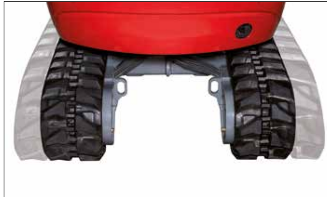
Raupefahrwerk mit hydraulischer Spurverbreiterung.
